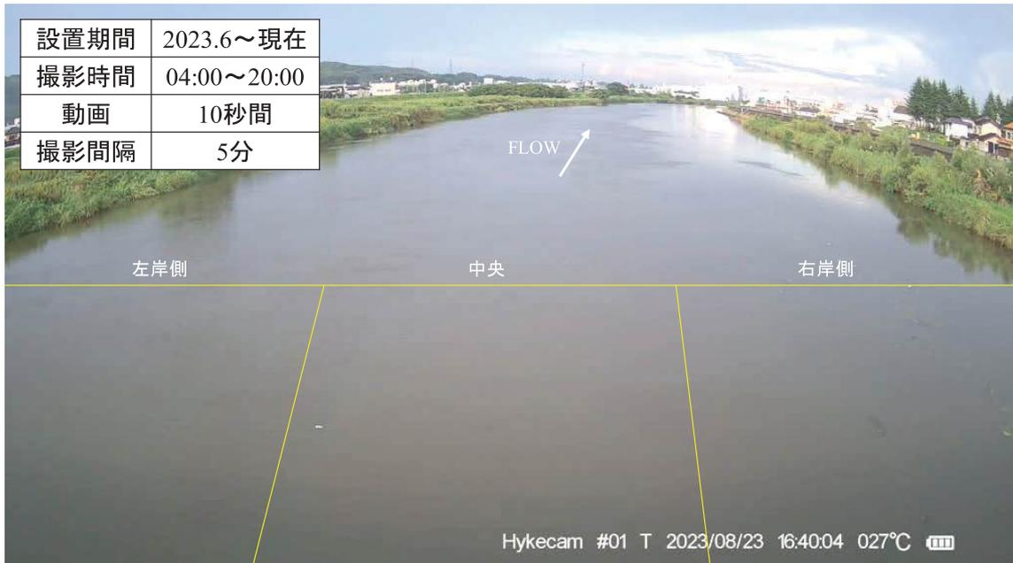
図-5 撮影画像の一例（小矢部川二上橋），3区間に分けて通過ゴミ数をカウント
